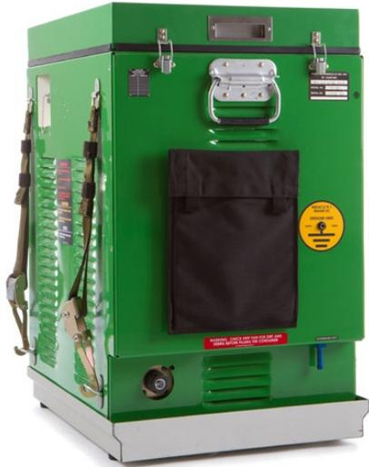
**BMOS-FS (Backpack Medical Oxygen Filling Station)** 는 여러 BMOS 또는 MMOS 시스템을 채운 후 사용하도록 설계된 저압 휴대용 20.0 리터 액체 산소 저장 장치입니다. 두 시스템 중 하나를 채우는 데 걸리는 평균 공급 시간은 약 3 분입니다. 외부 전력이 필요 없으며 단지 수량 표시기용 9V 배터리 2 개를 사용합니다.
